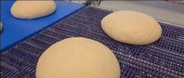
Fermentarea aluatului este verificata de o tehnologie AI care modifica automat temperatura si umiditatea in dospitor daca procesul tehnologic nu este in parametrii
