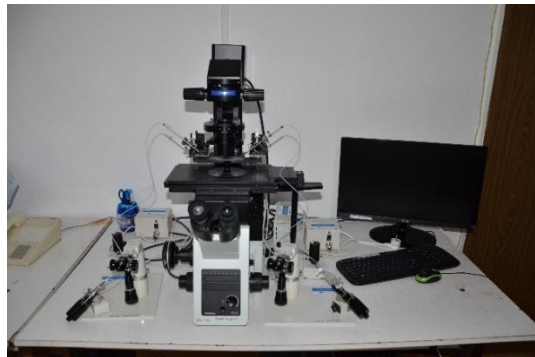
Figura 1. Microscop inversat cu sistem de micromanipulare.
