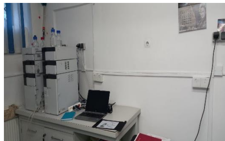
Figura 1. Sistem HPLC utilizat pentru separarea, identificarea și cuantificarea compușilor bioactivi.
